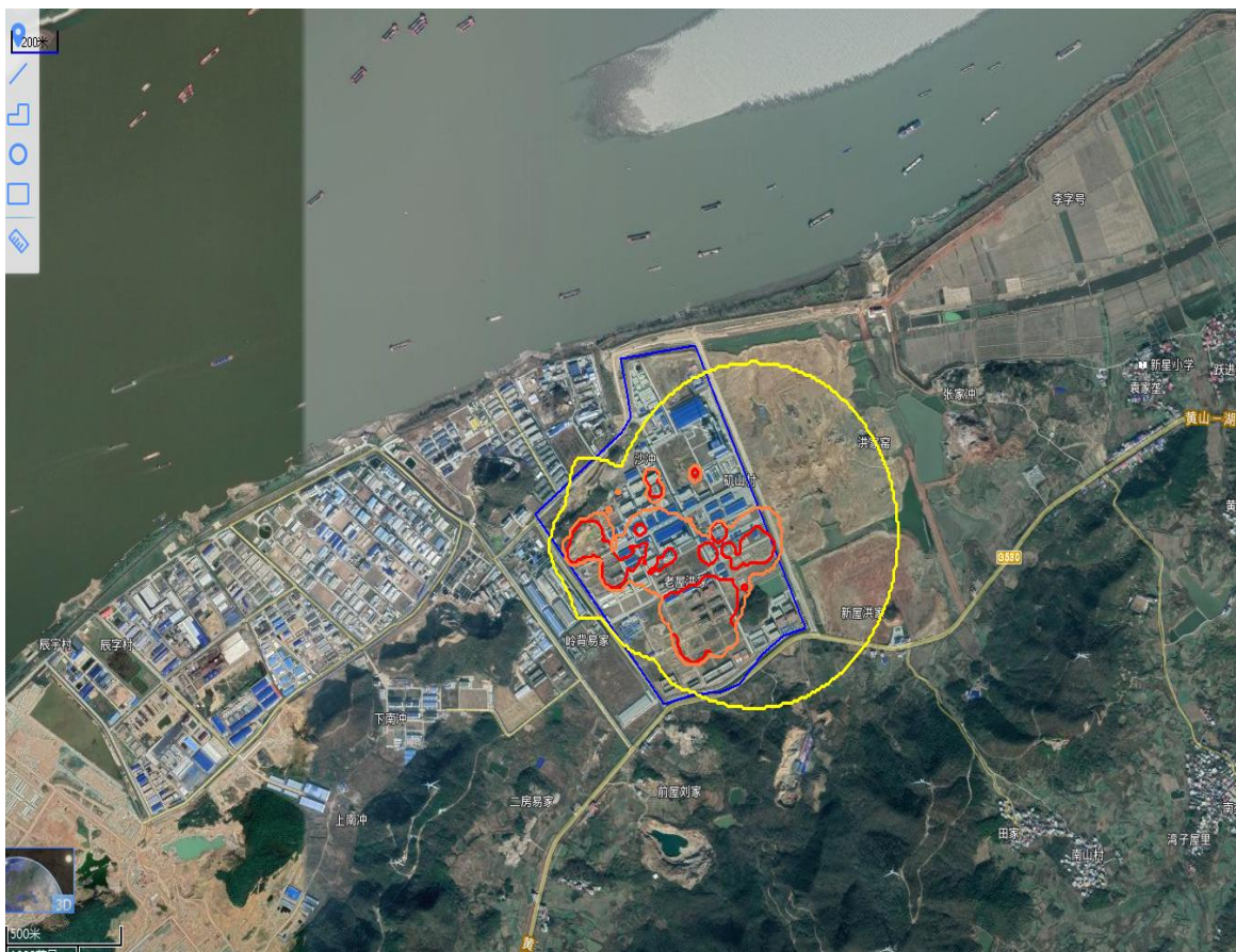
图 6.3-1 考虑企业所有生产装置和储存设施设施时个人风险等值线图
