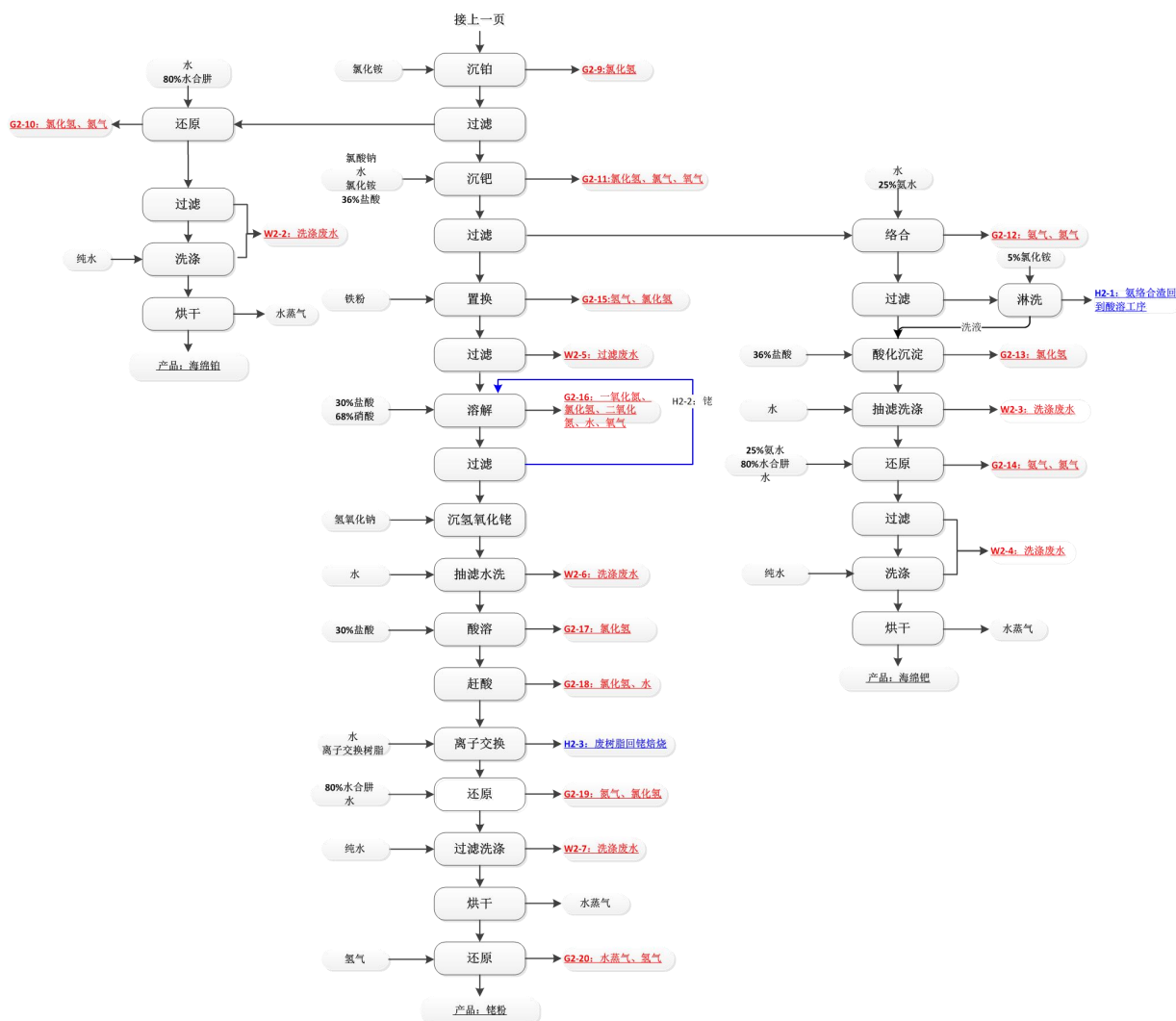
图 2.5-2 废汽车尾气铂钯铈三元催化剂废料综合利用工艺流程图
