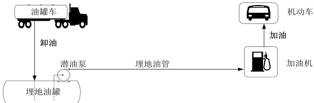
F图 1.2-2 柴油卸油、加油工艺流程图
