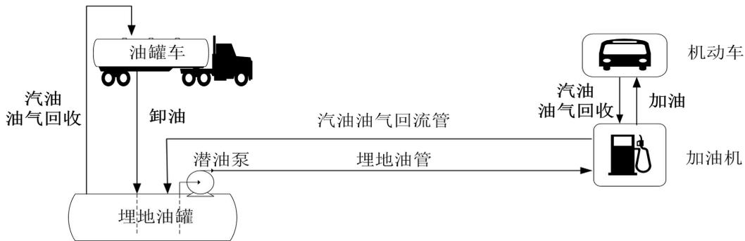
F图 1.2-1 汽油卸油、加油及油气回收工艺流程图
