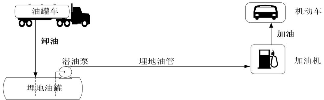
图 2.6-2 柴油卸油/加油工艺流程框图
