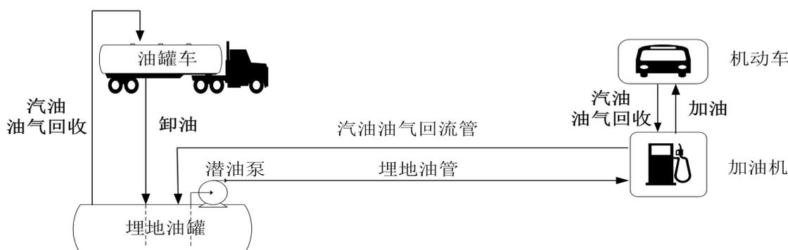
图 2.6-1 汽油卸油/加油工艺流程框图
